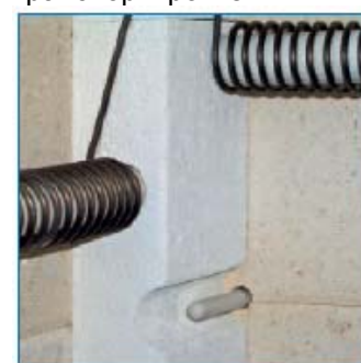
Термопара в защищенной позиции
